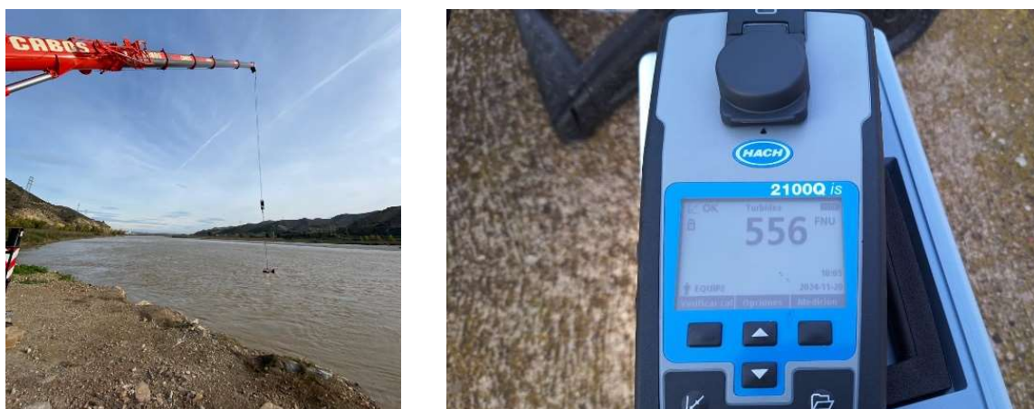
Figura 8. Equipos de muestreo y medición (a) Sonda Helley Smith sobre grúa y (b) turbidímetro
