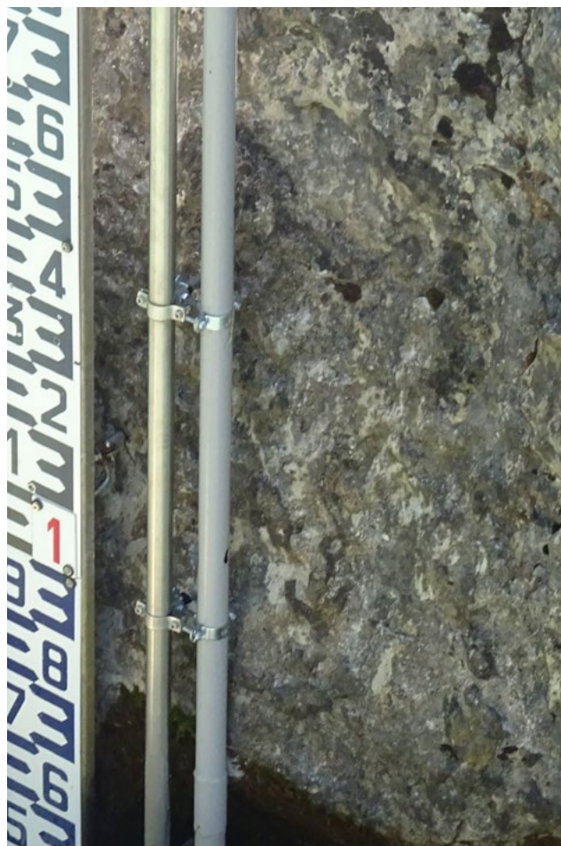
Escala limnimétrica en el río Irués
