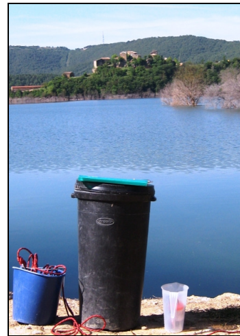
Figura 1: Arriba utensilios de muestreo: izquierda red de plancton de 50 \mu\text{m} , derecha receptor del material filtrado.
